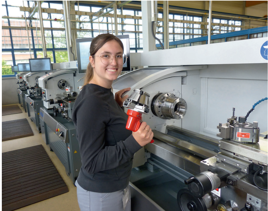
Elisa Jäger wechselt ganz leicht und im Handumdrehen die Spannköpfe im Torok-Spannfutter aus © Hainbuch
